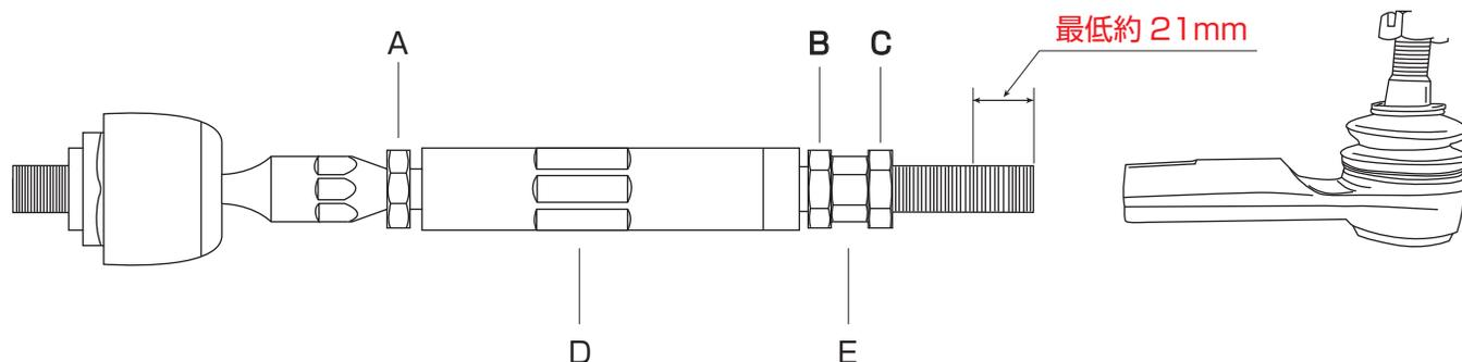
タイロッド長の調整を行う場合、基本的には C のロックナットを緩め、E のロッドを回して長さを調整します。
