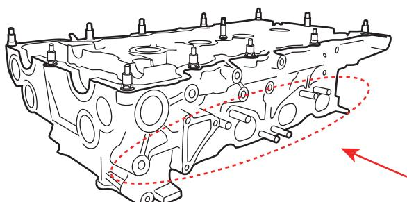
ガスケットを挟む面に段差やゴミがないか確認してください。
