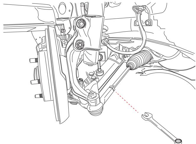
ナットが緩んだら、タイロッドエンドプーラーなどを使用して純正タイロッドエンドを取り外して下さい。
